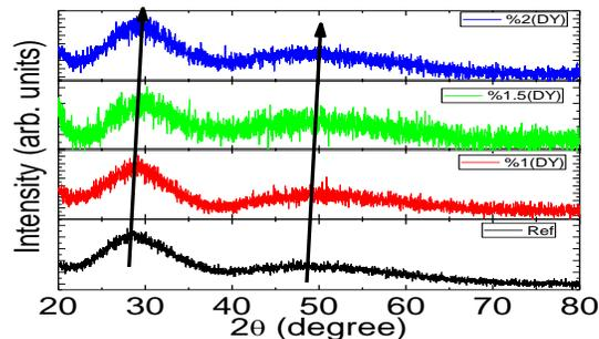
Fig.1: X-ray diffraction pattern of  $\text{Bi}_2\text{O}_3$ ;  $\text{PbO}$ ;  $\text{Li}_2\text{O}$ ;  $\text{CdO}$ ;  $\text{Ta}_2\text{O}_5$ ;  $\text{MgO}$ ;  $\text{B}_2\text{O}_3$ ;  $\text{Dy}_2\text{O}_3$ .
